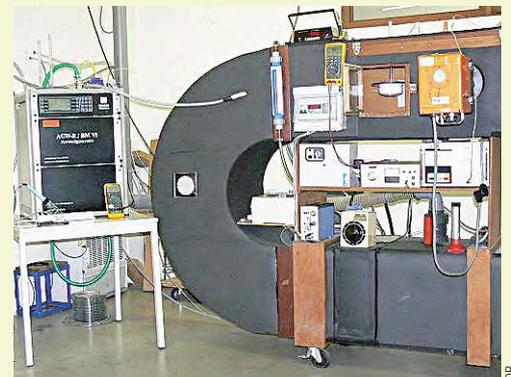
*Les détecteurs sont fixés dans un tunnel, dans lequel on introduit un aérosol qui produit un brouillard équivalent à de la fumée.*
